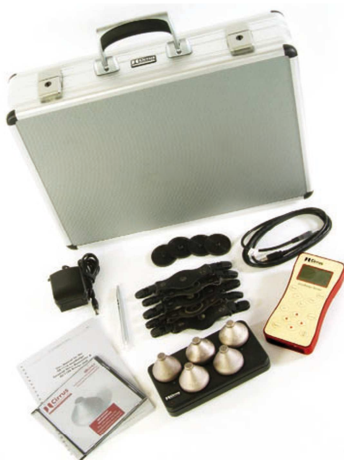
Vue d'un CR:110A/5 kit de mesure contenant 5 doseBadges
